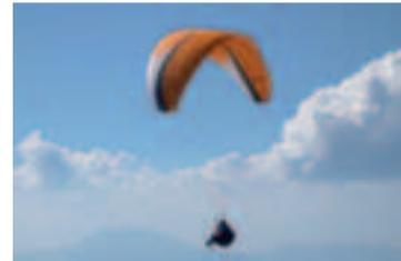
tabili. È costituito da un'ala alla quale è sospesa la selletta (un imbrago) del pilota tramite un sistema di fasci funicolari che permettono il controllo della vela permettendo accelerazione, freno e controllo di direzione. Come il deltaplano e il volo a vela sfrutta lo spostamento delle correnti d'aria con il volo termico e dinamico.
